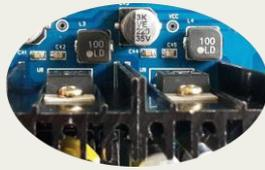
Source 전원이 되는 Battery 전원에서 유입되는 Noise와 이로 인해 발생하는 Error 요인을 없애기 위해 Line Filter를 장착하였다.
