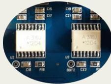
Current Buffer for Increased Drive Circuit을 채택하여 IGBT 용량의 확장이나 먼 거리의 제어가 용이하도록 설계하였다.
